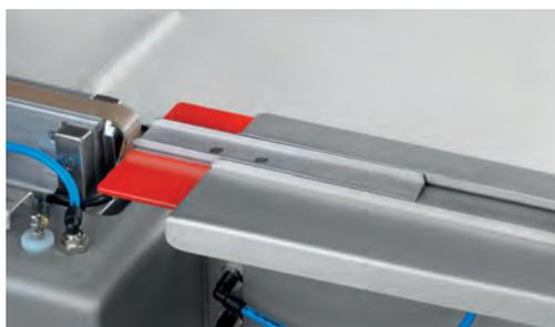
**Las barras selladoras refrigeradas por agua** aumentan la durabilidad del teflón y los alambres de sellado.
