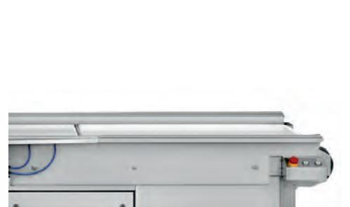
Una **cinta de alimentación sincronizada** sirve de ayuda durante la carga rápida y ergonómica de la máquina y es requisito indispensable para una ulterior automatización en la zona de carga.
