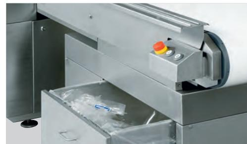
El **corte completo** corta los excedentes de bolsa de los envases directamente en la cámara de vacío. El sistema de aspiración aspira los restos de las bolsas a un depósito externo que se encuentra debajo de la cinta de carga previa y, de ese modo, se suprime completamente la retirada manual de los excedentes de bolsa.
